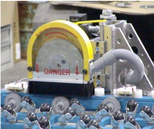
Foto de la rueda de decapación y el gabinete de recolección de polvo en un eliminador de tabla. Foto cortesía de ALKAB Contract Manufacturing.
