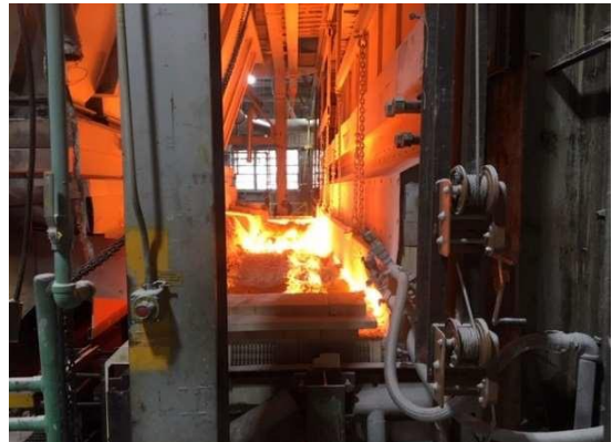
Extremo de carga del reactor térmico de vidrio
